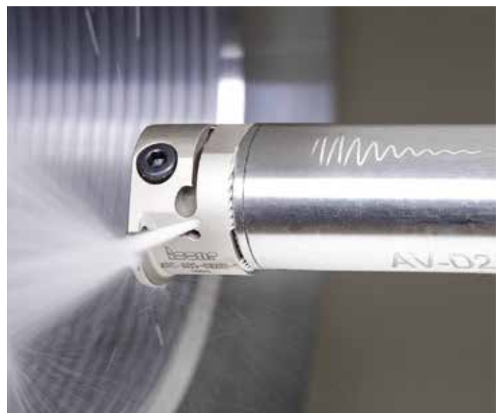
Fig 3 -Vibrationsdämpande bom med utbytbart huvud och serraterad anslutning gör användningsområdet för uppborrninng och gängning avsevärt större.
